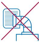
присоединение дымоотводов от газового оборудования к вентиляционным каналам.
