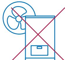
Не включайте вентилятор в ванной комнате, когда работают газовый котёл или водонагреватель.
