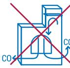
эксплуатация газовой отопительной печи при закрытом шибере (задвижке).
